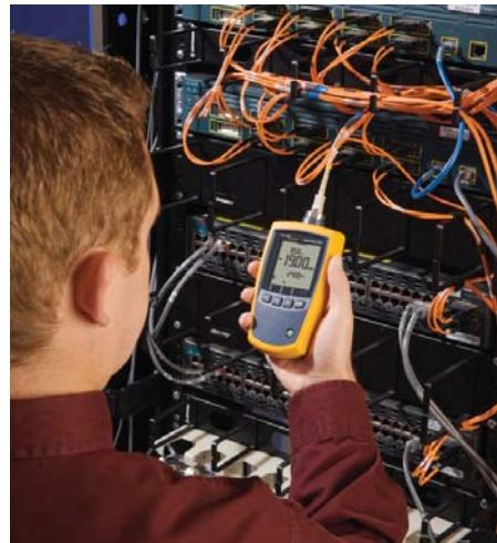
光功率计在六个波长(850、1300、1310、1490、1550、1625)上作了准确度校准。所有的工具包都包含光功率计。光功率计有一个直观的四键面板，一个大型 LCD 显示屏和串行数据端口，能保存光功率的基准值，便于直接显示光缆的损耗值。活型连接器容许简单的网络连接及简单的基准功率测量。可更换的连接适配器适合匹配全部最常见的连接器类型。
