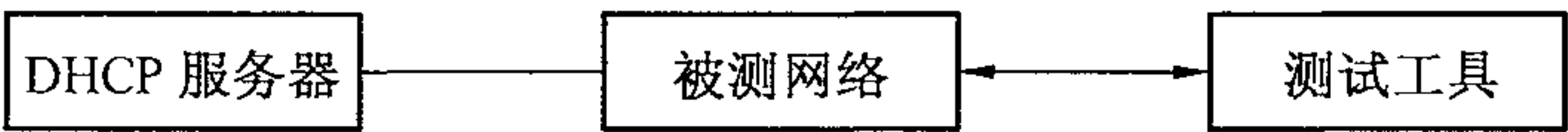
图 8 DHCP 服务性能测试结构示意图
