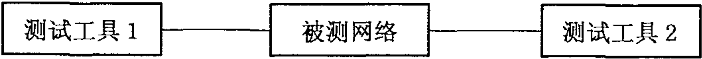
图 14 VLAN 划分测试结构示意图
